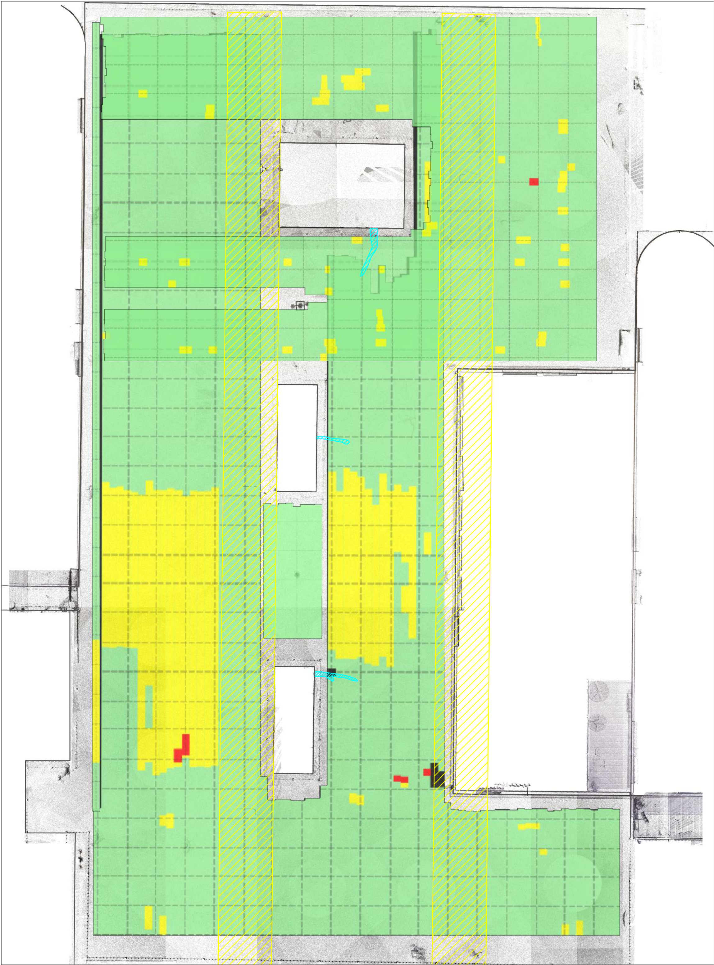
AREA 2 - GPR CORROSION RESULTS- BOTTOM REBAR MAT SCALE: 1:80
