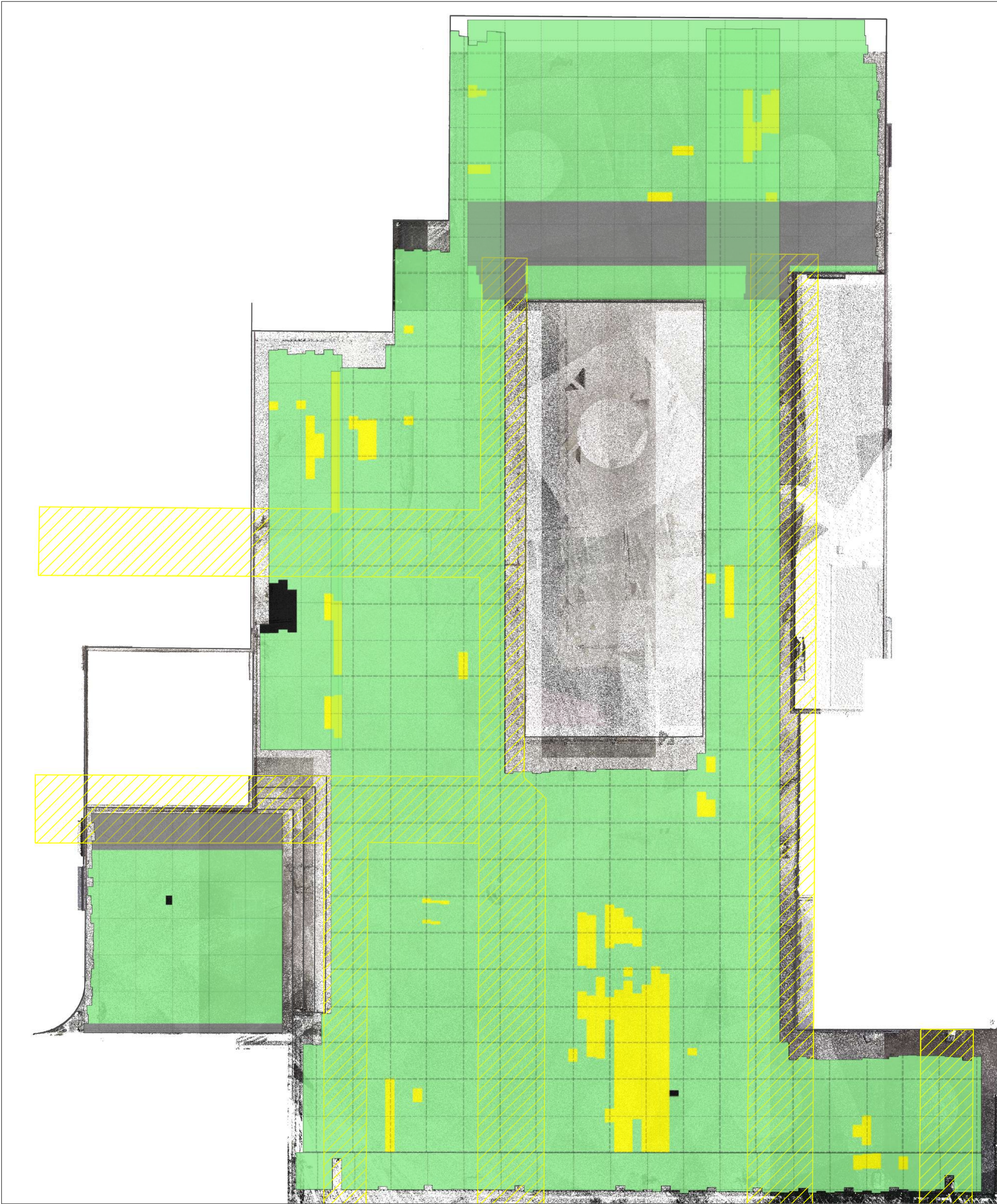
AREA 1 - GPR CORROSION RESULTS- BOTTOM REBAR MAT SCALE: 1:80
